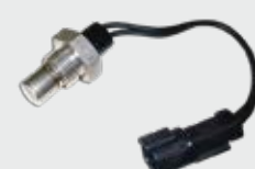
CONTACT TEMP. EN SERVICE INTENSIF 225°F N/C FILETAGE : 3/4 UNO PIÈCE N° 8491
