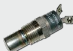
CONTACT TEMP. EN SERVICE INTENSIF 219°F N/C FILETAGE : 3/8 NPT PIÈCE N° 1765
