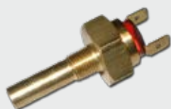
CONTACT TEMP. EN SERVICE RÉDUIT 212°F N/C FILETAGE : 1/8 NPT PIÈCE N° 9454
